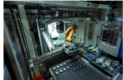
Zink und Kunststoff sind mithilfe der Hybridtechnologie eine starke Kombination: Die gegossenen Bauteile werden mit Kunststoff umspritzt und mithilfe von Kameras und 3-D-Scannern genauestens geprüft. (Bildquelle: Andreas Bednarek)
