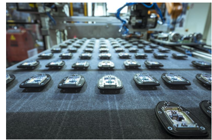
1,2 Millionen Bodenplatten für eine Autodachantenne verlassen jährlich das Werk. (Bildquelle: Andreas Bednarek)
